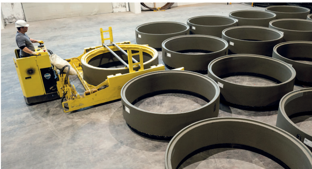
Свежееотформованные изделия аккуратно доставляются в сушильную камеру с помощью транспортной тележки с электроприводом и встроенным манипулятором
