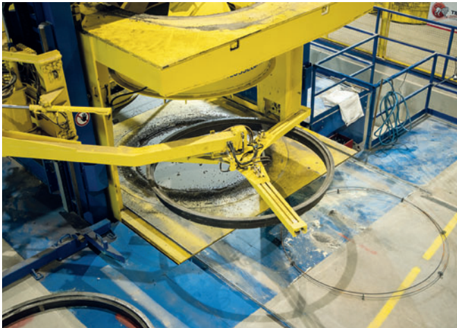
Стальной нижней поддон автоматически передается в машину для каждого производственного цикла
